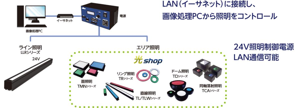
LAN(イーサネット)に接続し、画像処理PCから照明をコントロール
