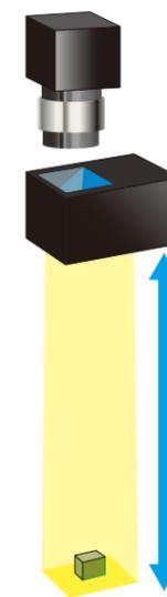
高出力化によりワークとの距離を長くでき欠陥検出精度を向上
