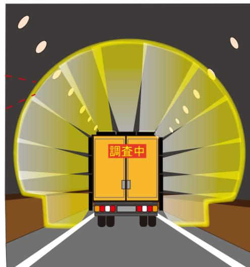
トンネル壁面検査、路面検査
