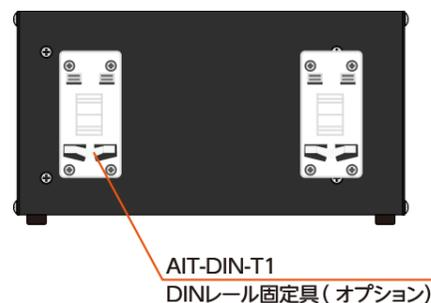
オプションで配電盤内設置に最適なDINレール固定具を取付可能
