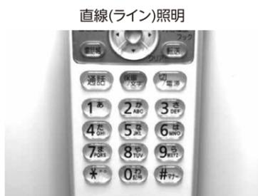
直線(ライン)照明の直射光ではボタン部の凹凸の陰影やハレーションがおき文字認識がしにくい
